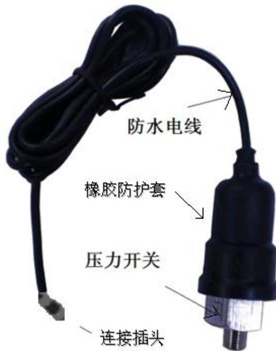
本描述以 1 号阀为例，说明，按照上述第 1 步，连接好 1 号压力开关的插头，然后在 1 号阀出水口，接上一个三通转接头，目的是为了能将 1 号压力开关安装到 1 号阀出水管道上，使得 1 号压力开关能检测到 1 号阀出水口的压力。
