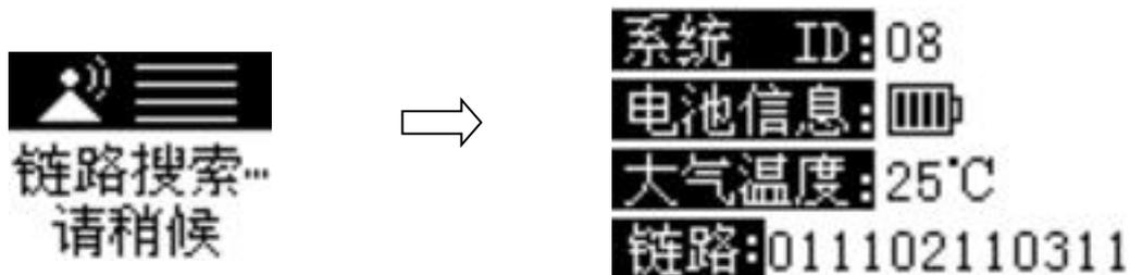
搜到路径后设备将上传路径信息给主机,若上传成功,主机LCD上将会有设备信息显示,主机设备信号栏上将会有信号显示,例如传感器的信息栏如下图:
